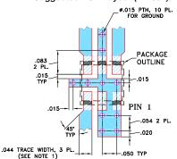
NOTES: 1. TRACE WIDTH IS SHOWN FOR ROGERS R04350B WITH DIELECTRIC THICKNESS .020" ± .0015"; COPPER: 1/2 OZ. ON EACH SIDE. FOR OTHER MATERIALS TRACE WIDTH MAY NEED TO BE MODIFIED. 2. BOTTOM SIDE OF THE PCB IS CONTINUOUS GROUND PLANE. DENOTES PCB COPPER LAYOUT WITH SMOBC (SOLDER MASK OVER BARE COPPER) DENOTES COPPER LAND PATTERN FREE OF SOLDER MASK
